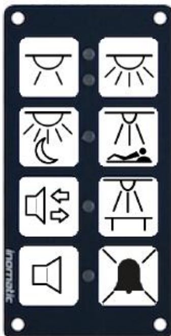
Rys. 5 Widok klawiatury dodatkowej w przedziale medycznym znajdującej się wewnątrz przedziału.
