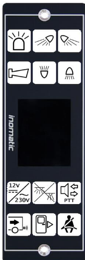
Rys. 1 Widok klawiatury z ekranem w przedziale kierowcy
