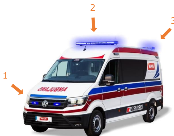
Rys. 8 Rozmieszczenie sygnalizacji uprzywilejowanej
