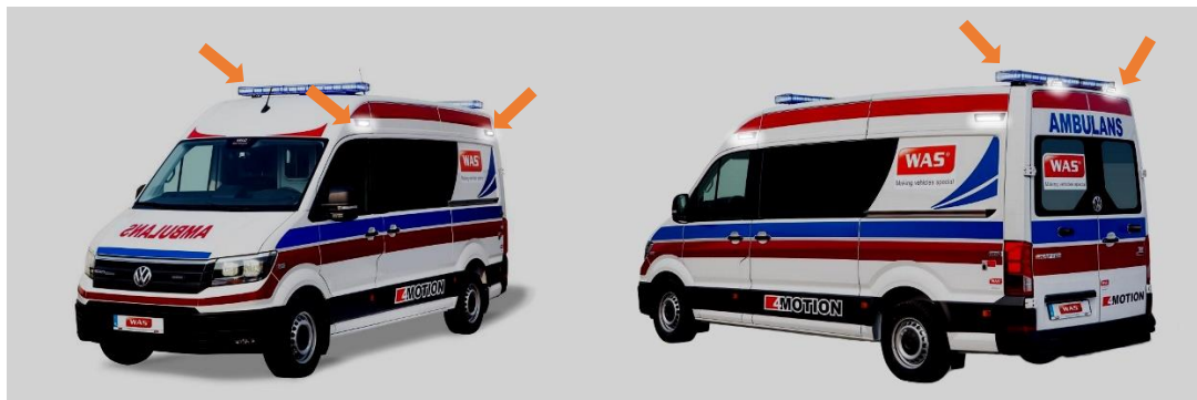
Rys. 9 Rozmieszczenie świateł roboczych na pojeździe
