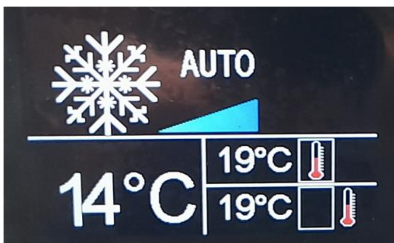
Rys. 7 Widok informacji wyświetlanej na wyświetlaczu LCD klawiatury w przedziale medycznym(chłodzenie)
