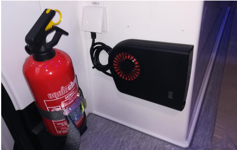
Rys. 25. Lokalizacja stacjonarnego ogrzewania przedziału medycznego zasilanego z sieci 230V (DEFA 2100 W)
