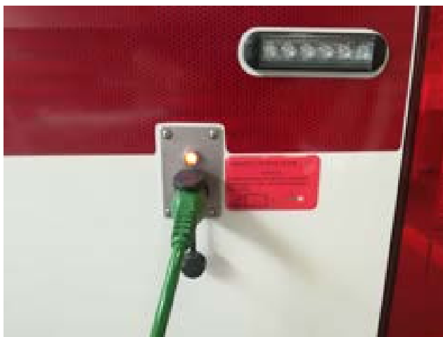
Rys. 66. Podpięcie zewnętrznego zasilania 230V.
