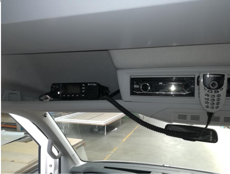
Rys. 40. Widok radiotelefonu w schowku nad głową kierowcy.
