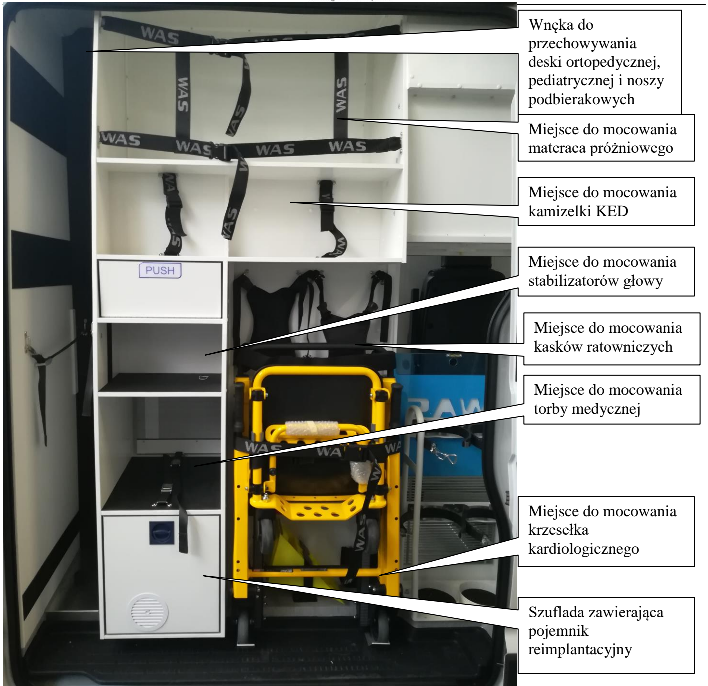
Rys. 64. Mocowanie sprzętu ortopedycznego za lewymi drzwiami przesuwными.
