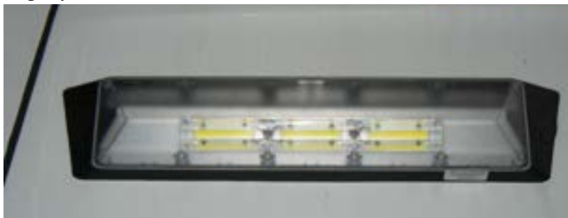
Rys. 29. Światła robocze umieszczone w obudowach zintegrowanych z nadwoziem pojazdu – lewa i prawa strona ambulansu
