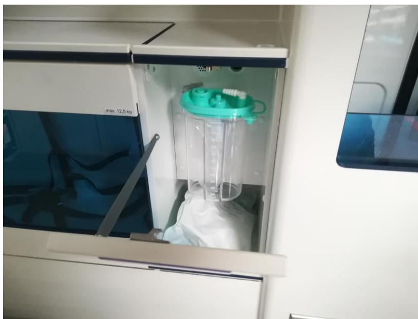
Rys. 36 Umieszczenie słoja próżniowego w pojeździe.
