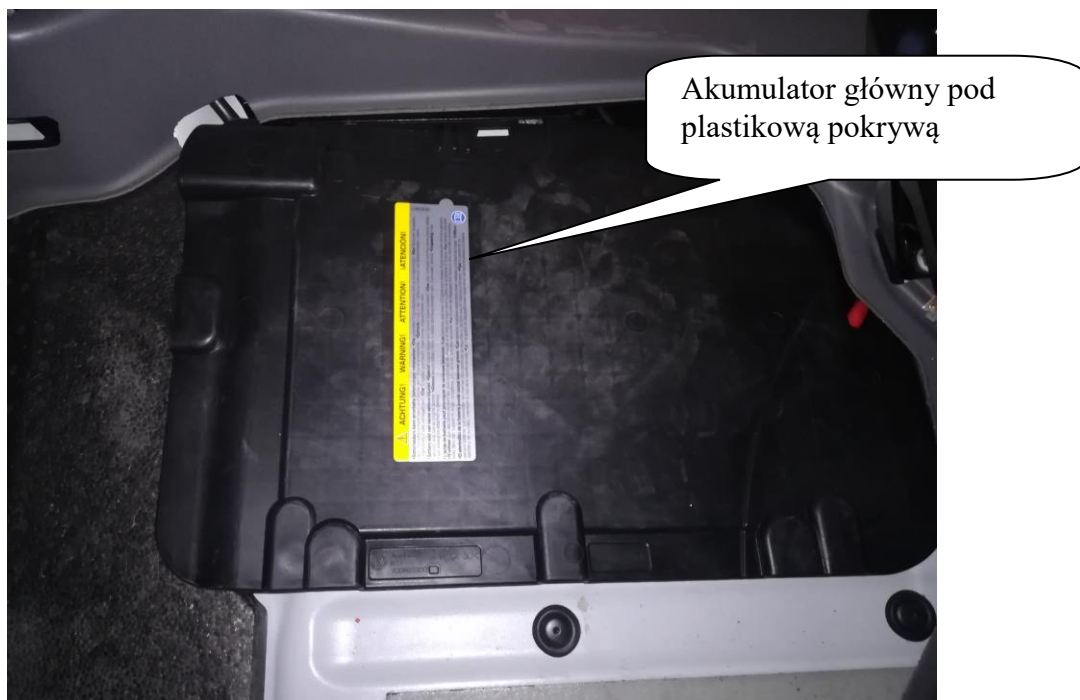
Rys. 6. Umieszczenie akumulatora głównego
