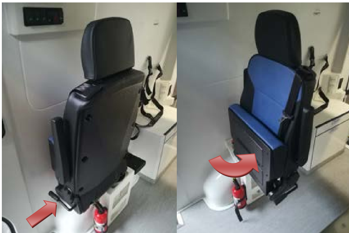
Rys. 50 Użycie dźwigni w celu obrotu fotela o kąt 90°
