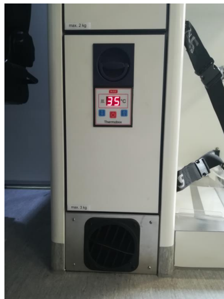
Rys. 28. Schowek z funkcją podgrzewania płynów infuzyjnych „Termobox”.
