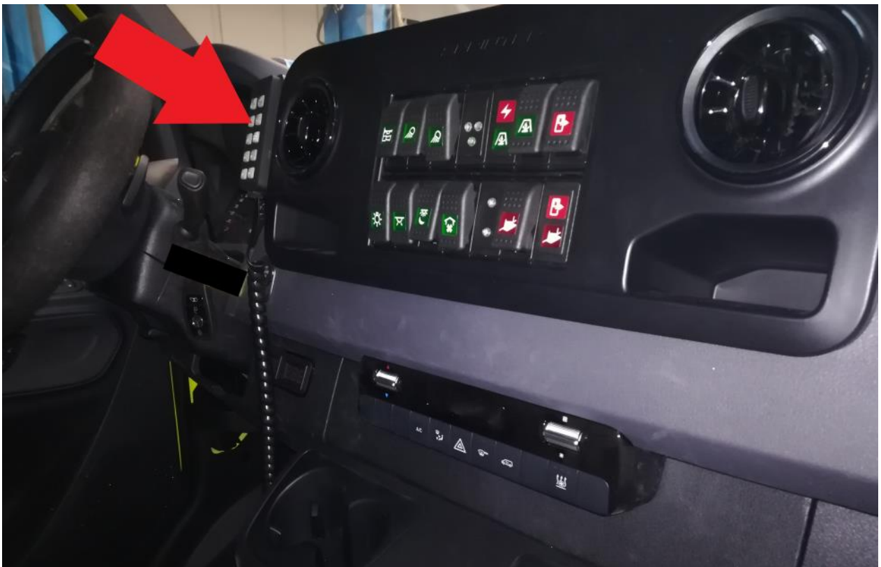
Rys. 32. Umieszczenie manipulatora w przedziale kierowcy
