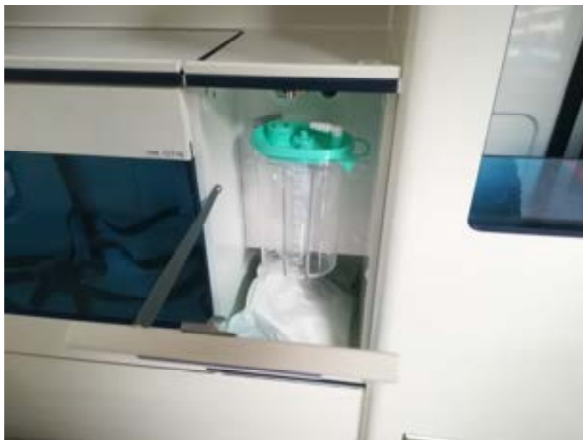
Rys. 36 Umieszczenie słoja próżniowego w pojeździe. Pompa próżniowa załączana jest poprzez panel sterujący lub dedykowane urządzenie sterujące. Szczegóły w oddzielnej instrukcji urządzeń sterujących.
