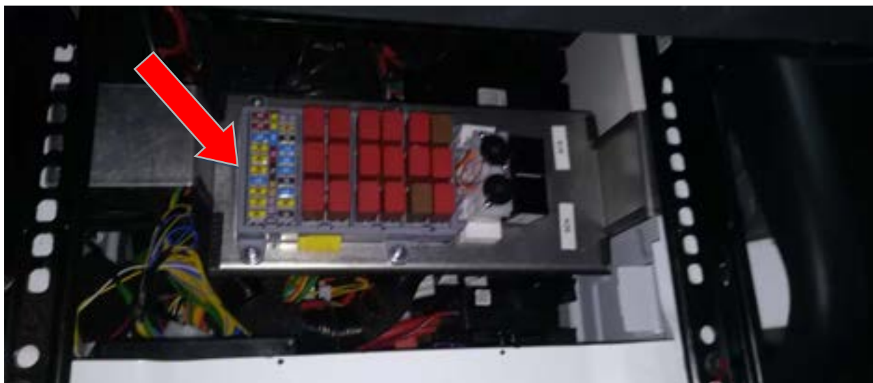
Rys. 67. Umiejscowienie bezpieczników pod fotelem kierowcy.
