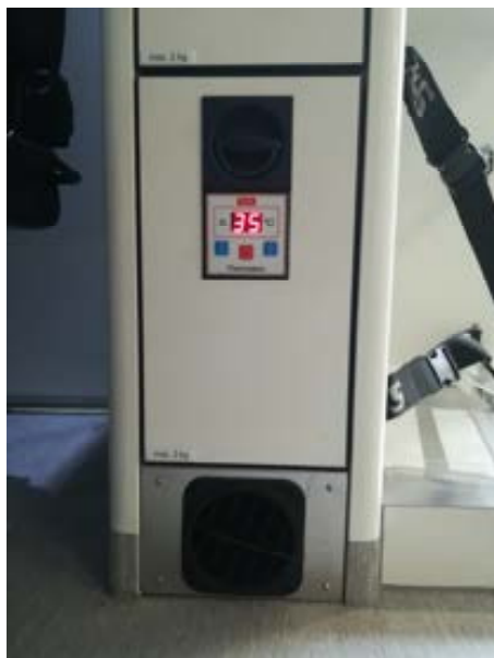
Rys. 28. Schowek z funkcją podgrzewania płynów infuzyjnych „Thermobox”.
