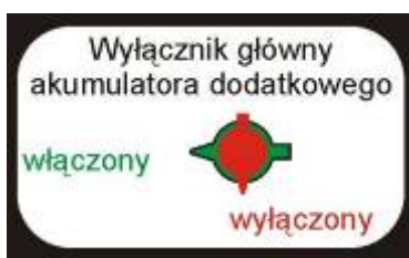
Rys. 14. Etykieta położenia wyłącznika akumulatora dodatkowego
