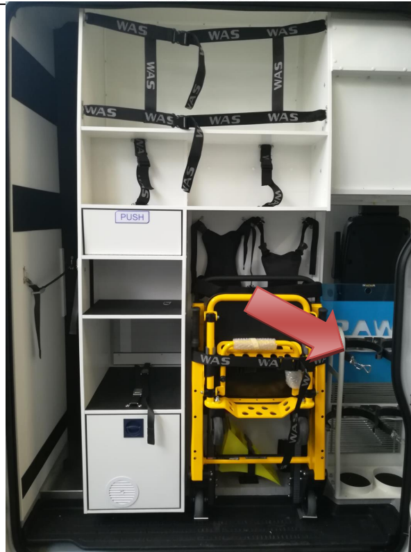
Rys. 61. Lokalizacja stojaka z butlami tlenowymi 10 litrów.
