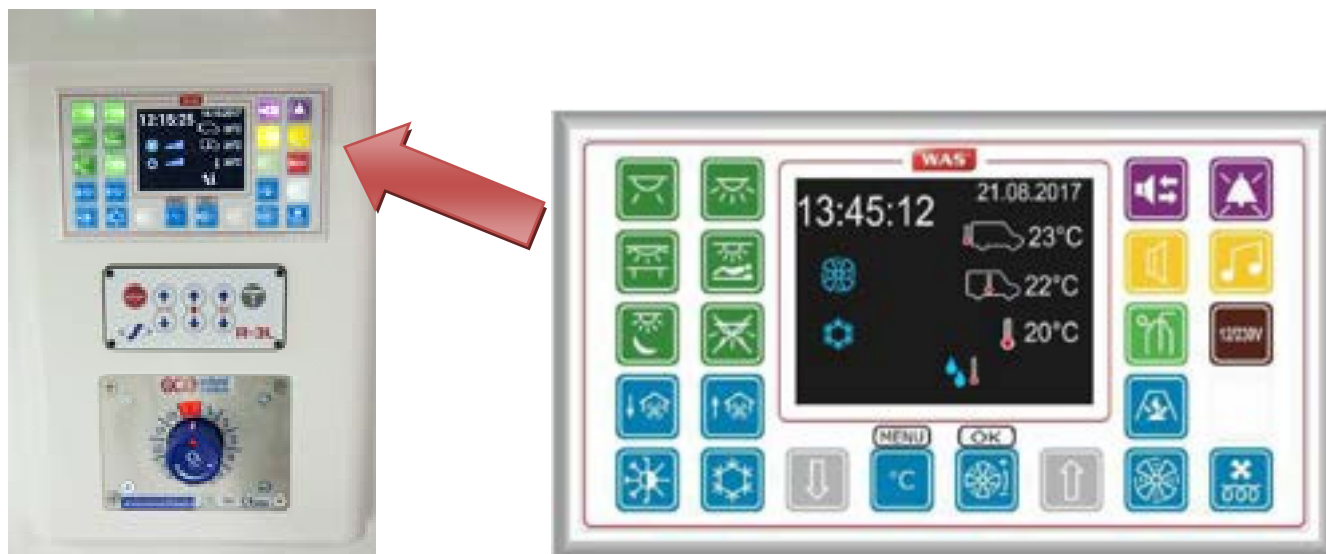
Rys. 16. Umieszczenie panelu sterującego w przedziale medycznym
