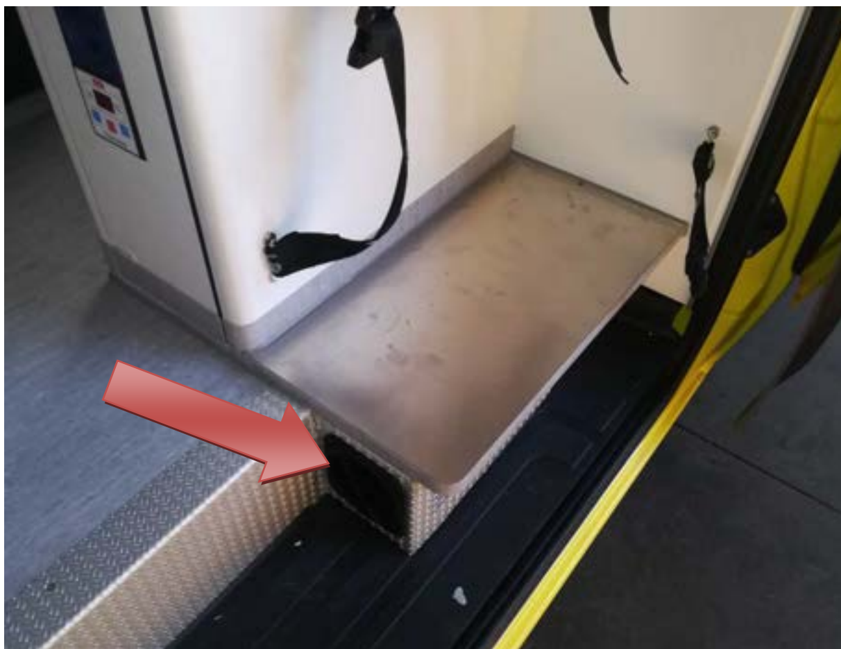
Rys. 20 Lokalizacja dyfuzora ciepłego powietrza
