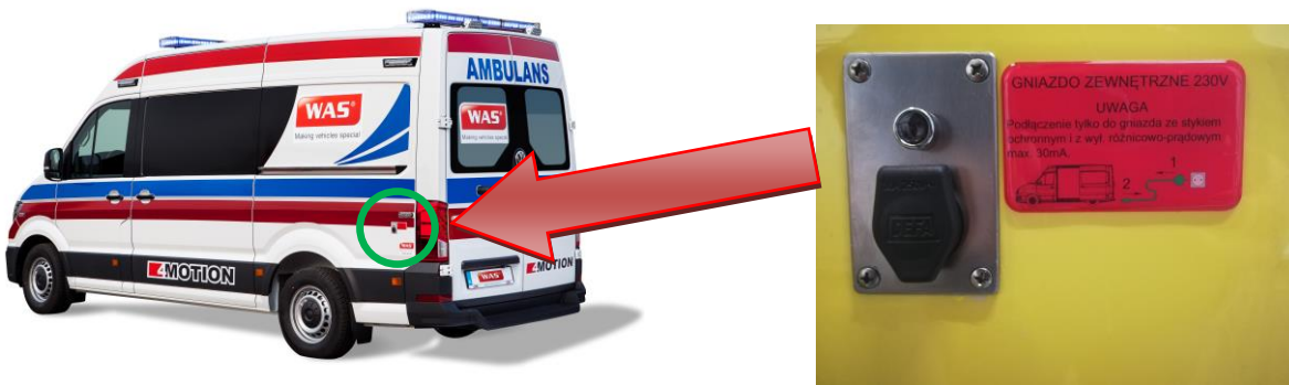
Rys. 4. Umieszczenie zewnętrznego gniazda zasilania 230V.
