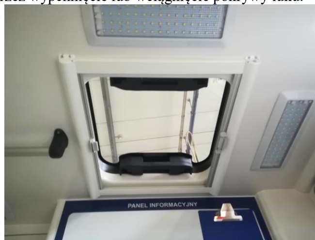
Rys. 54 Luk dachowy manualny zamontowany w przedziale medycznym
