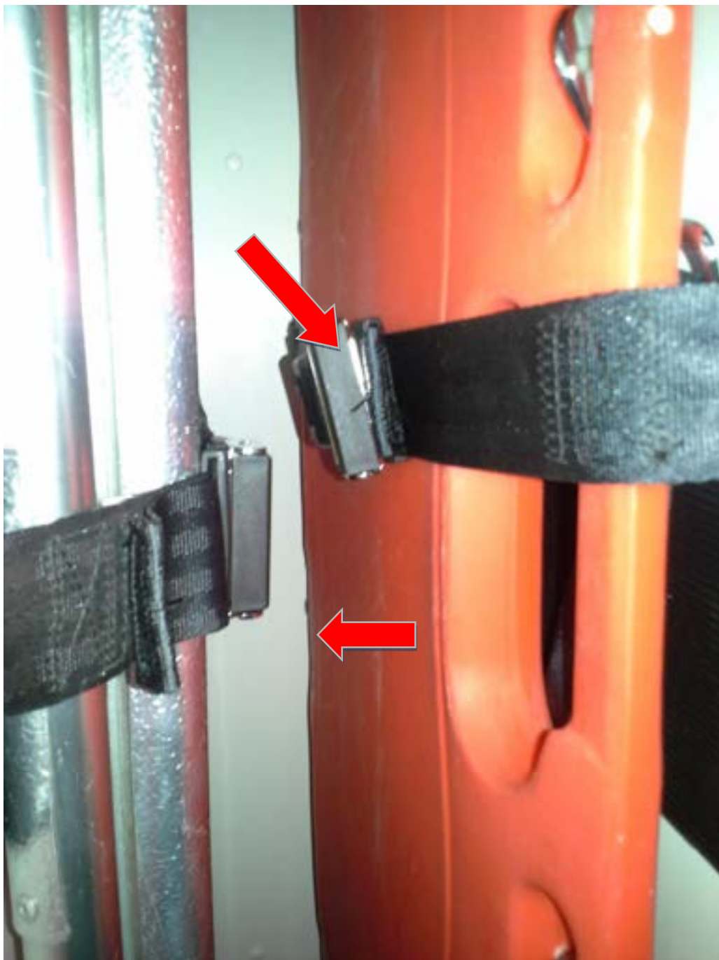
Rys. 65. Sposób mocowania noszy podbierakowych oraz deski ortopedycznej.
