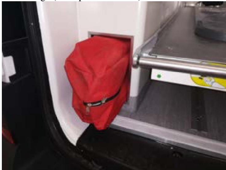
Rys. 56. Umieszczenie wnęki na szyny Kramera
