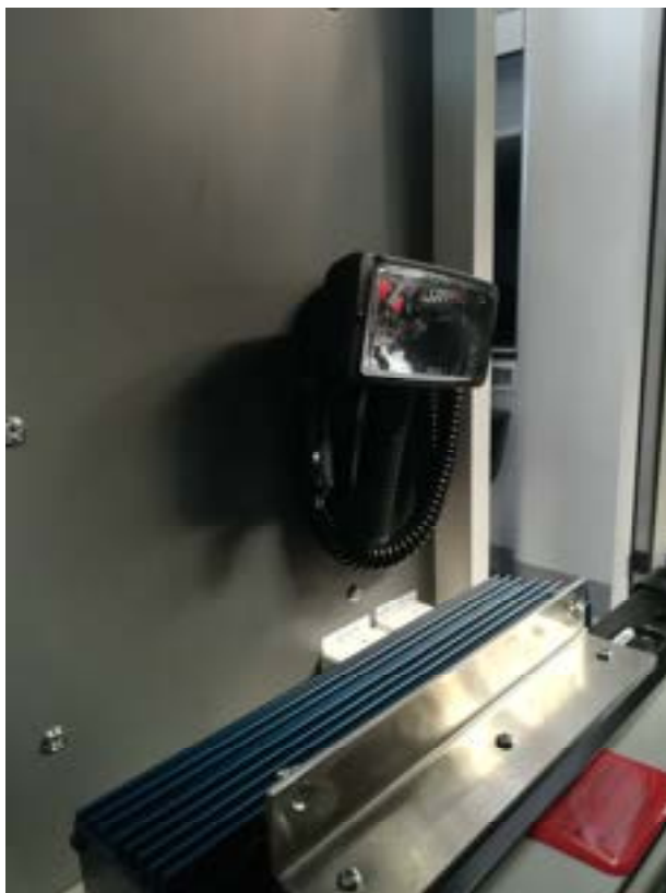
Rys. 42. Szperacz na elastycznym przewodzie w kabinie kierowcy
