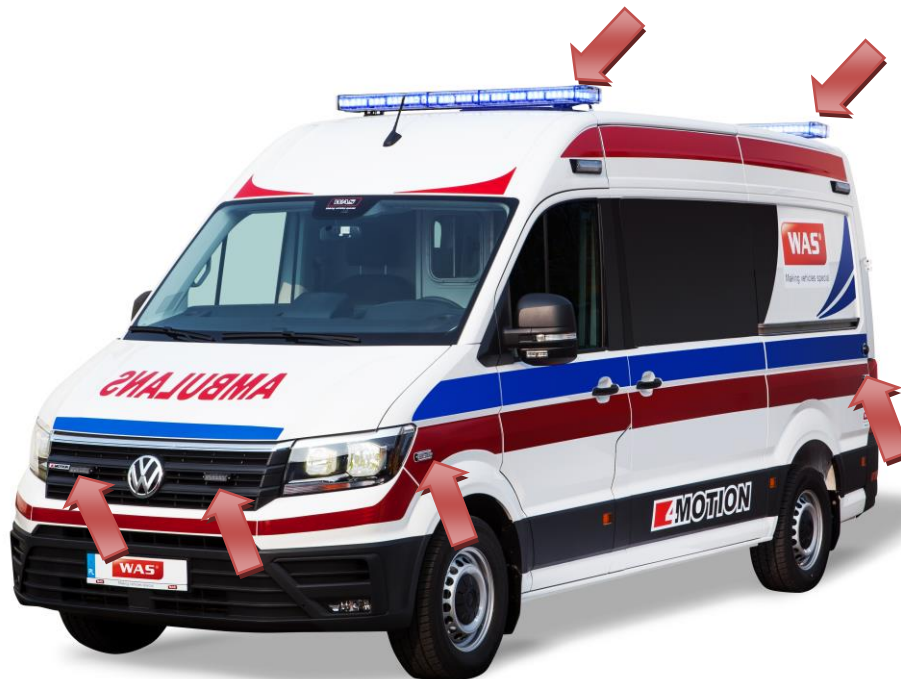
Rys. 33. Widok ambulansu z zamontowanym oświetleniem uprzywilejowanym.
