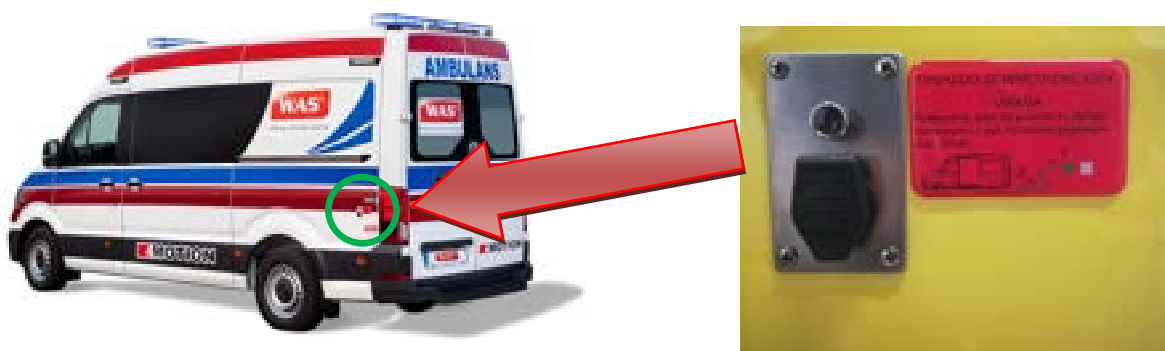
Rys. 4. Umieszczenie zewnętrznego gniazda zasilania 230V.
