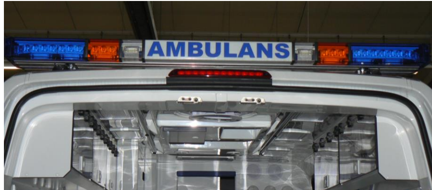
Rys. 30. Światła robocze zintegrowane z oświetleniem uprzywilejowanym – tył ambulansu
