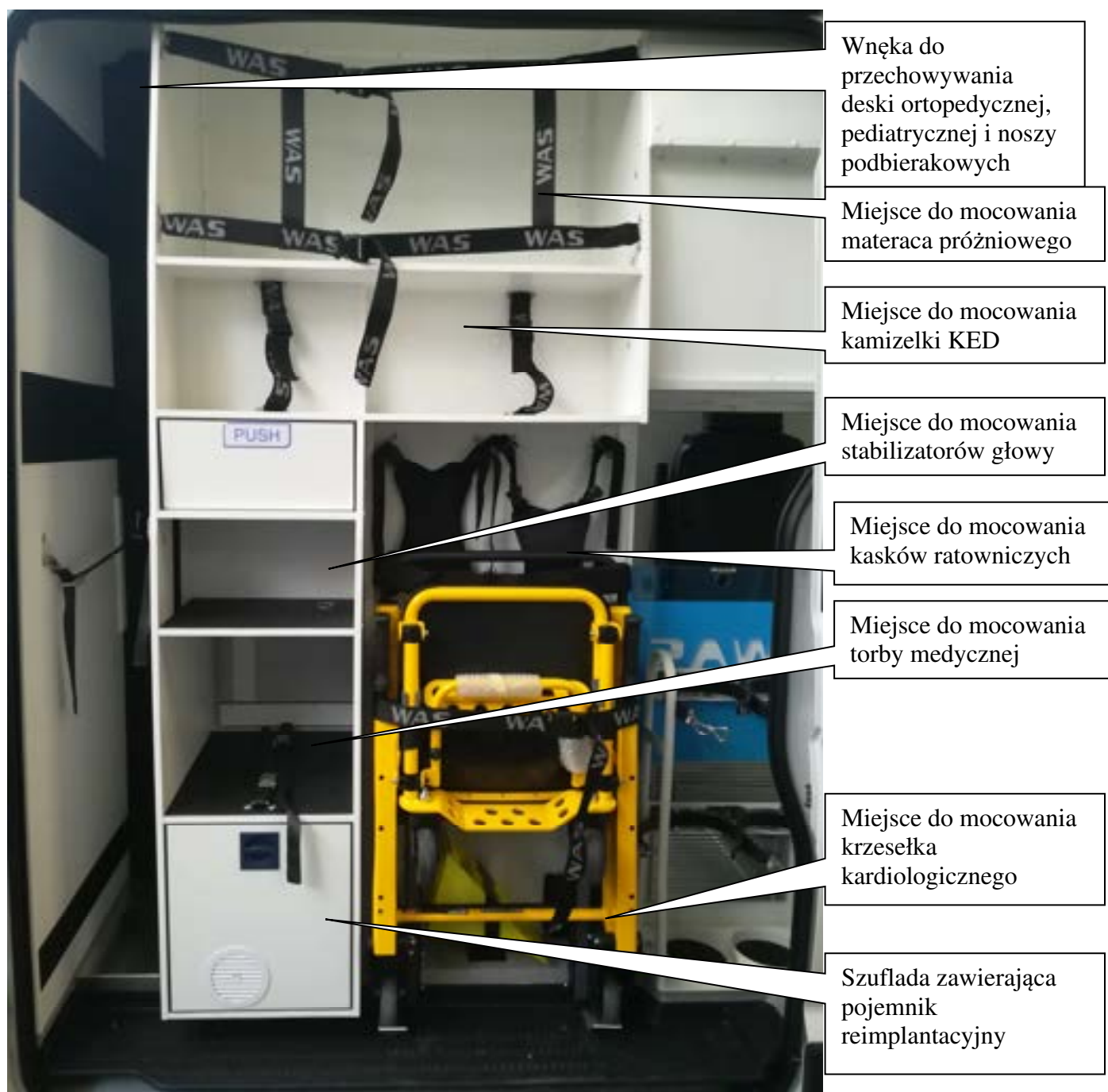
Rys. 64. Mocowanie sprzętu ortopedycznego za lewymi drzwiami przesuwными.
