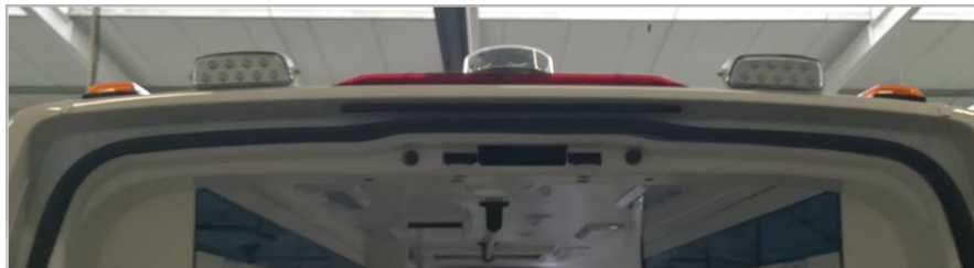
Rys. 31. Dodatkowe światła robocze wraz z kierunkowskazami
