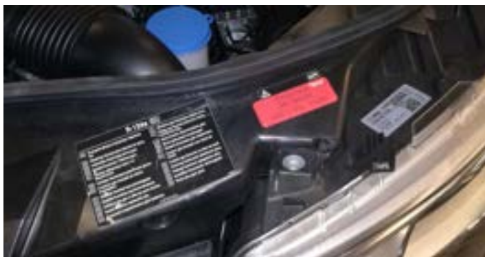
Rys. 23. Etykieta w komorze silnika informująca o koniecznej ilości gazu R134a.
