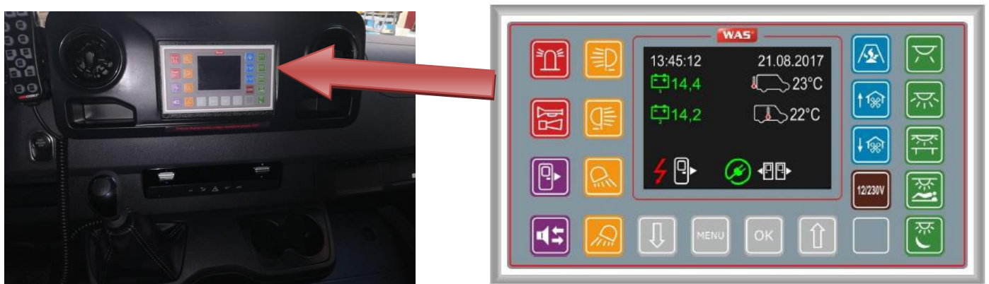
Rys. 17. Umieszczenie panelu sterującego w kabinie kierowcy
