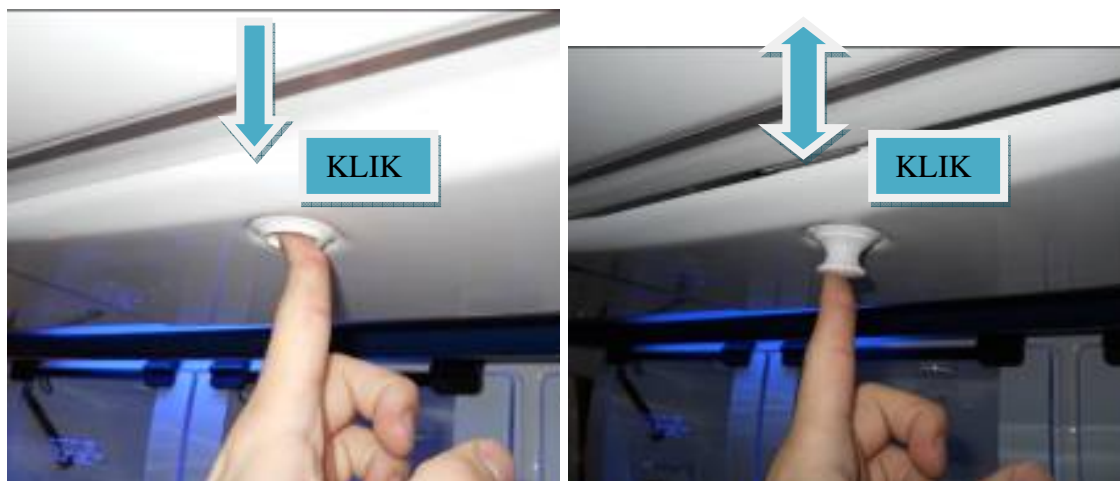
Rys. 43 System otwierania elementów meblowych „KLIK”.
