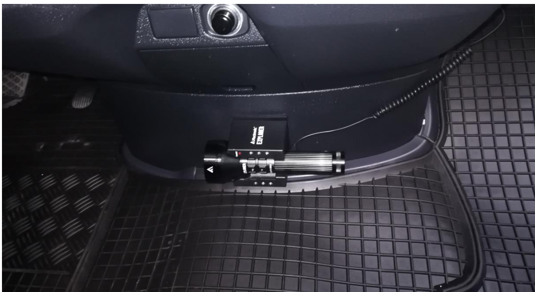
Rys. 41. Szperacz bezprzewodowy w kabinie kierowcy
