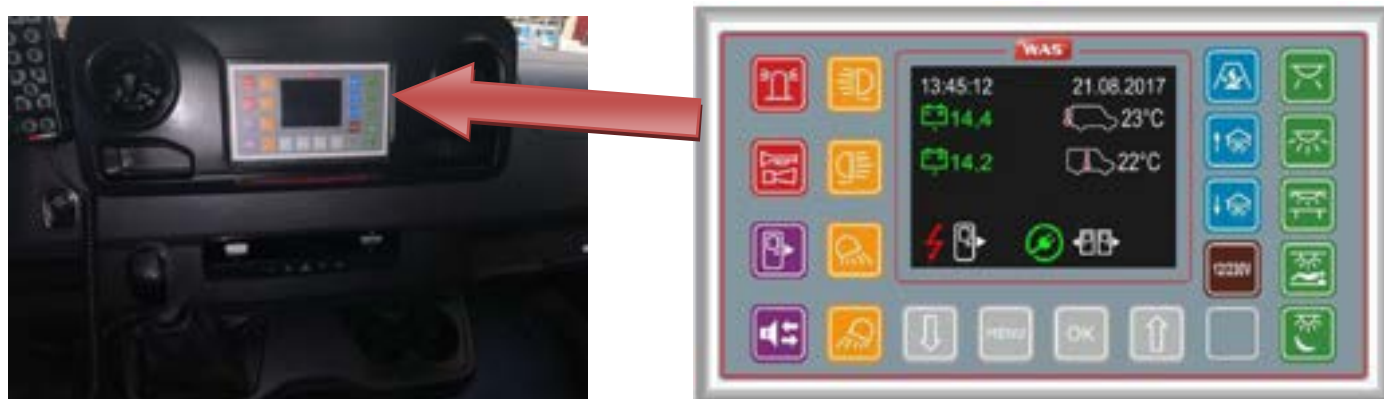
Rys. 17. Umieszczenie panelu sterującego w kabinie kierowcy
