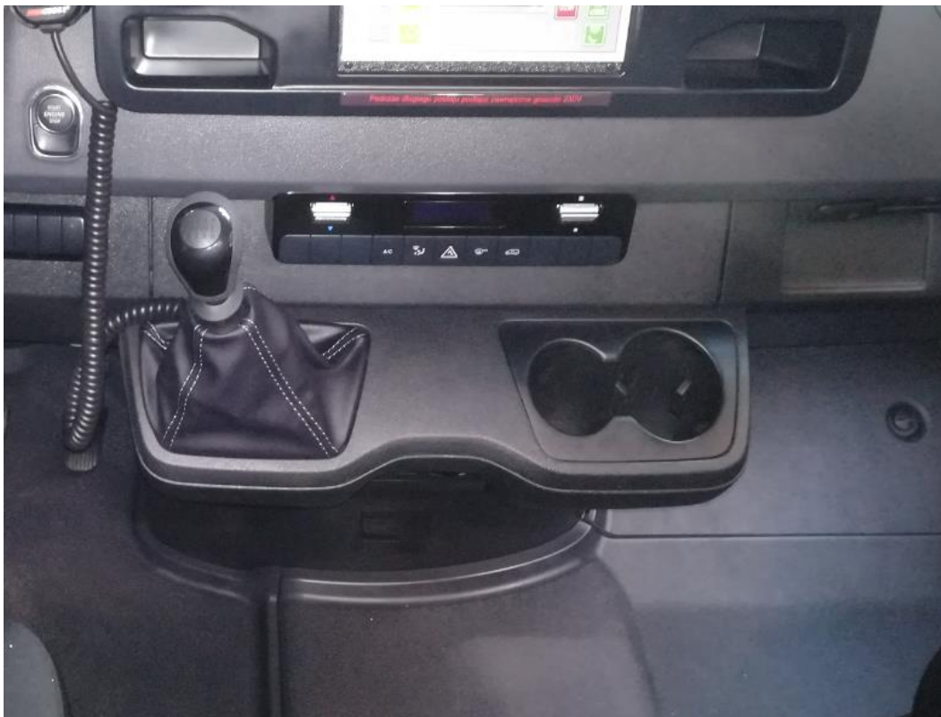
Rys. 21 Położenie przycisku do uruchomienia klimatyzacji przedziału kierowcy
