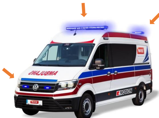
Rys.8 Rozmieszczenie sygnalizacji uprzywilejowanej
