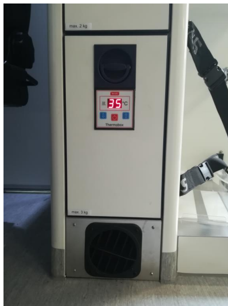
Rys. 28. Szuflada ogrzewacza płynów infuzyjnych (termobox).
