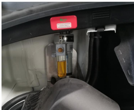
Rys. 15 Umieszczenie kompresora trąb Fiamm
