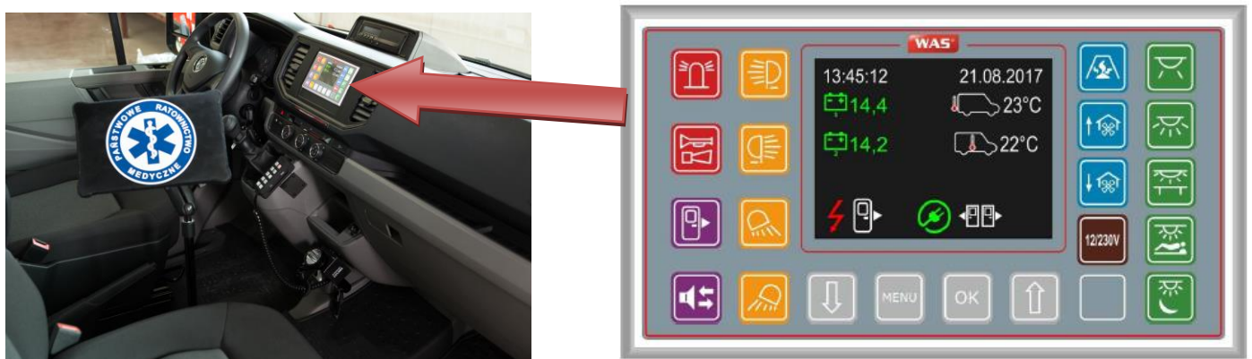
Rys. 17. Umieszczenie panelu sterującego w kabinie kierowcy
