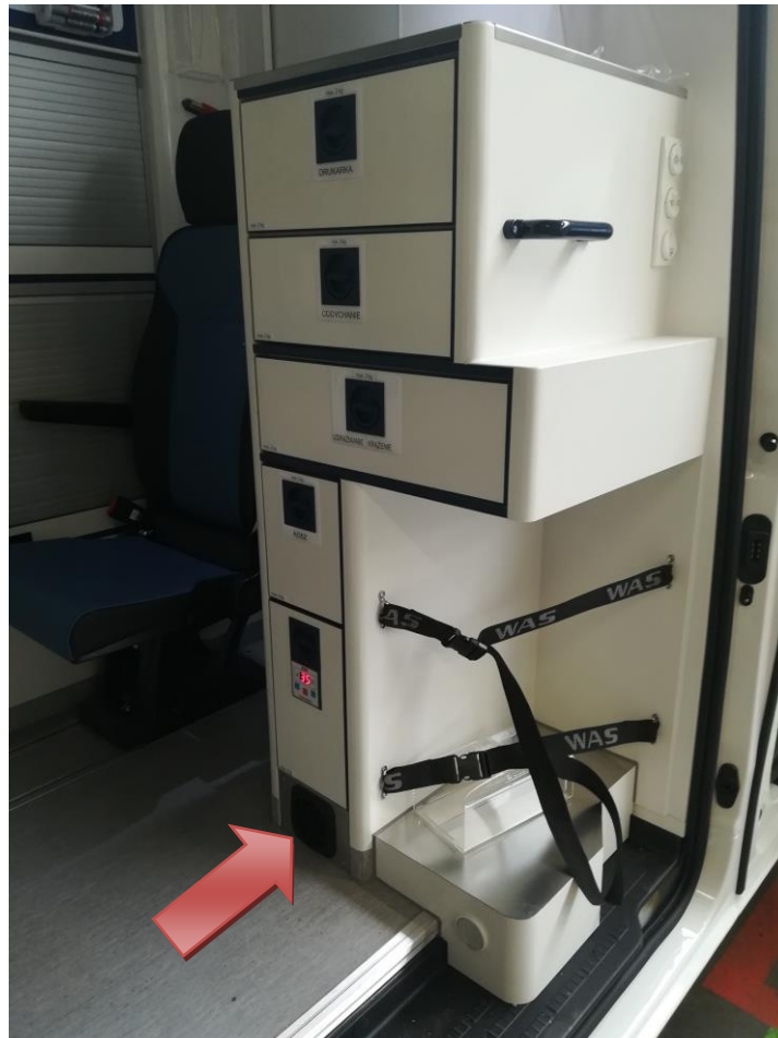
Rys. 20 Lokalizacja dyfuzora ciepłego powietrza
