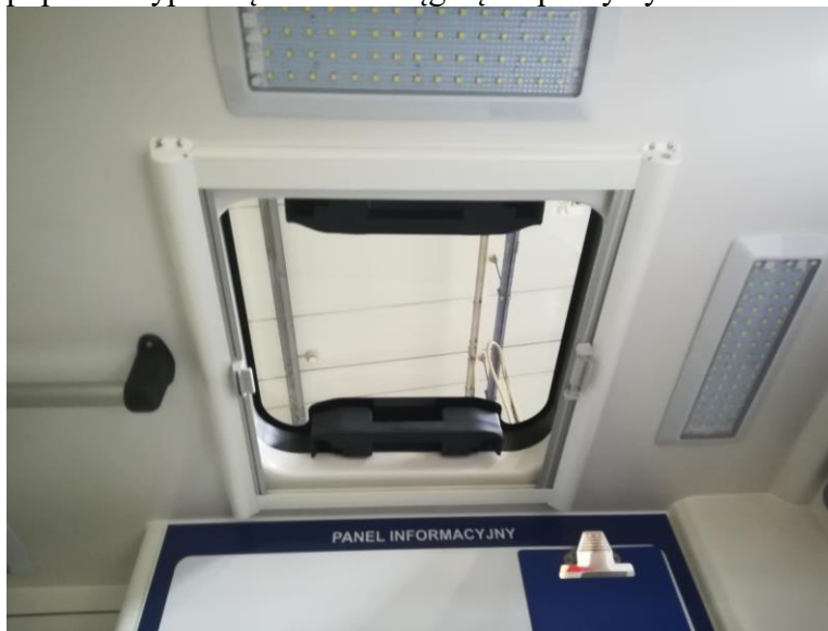
Rys. 55 Luk dachowy manualny zamontowany w przedziale medycznym
