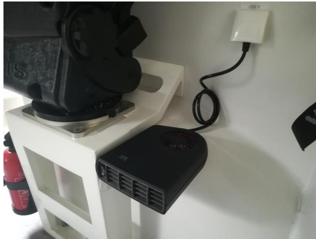
Rys. 25. Lokalizacja stacjonarnego ogrzewania przedziału medycznego zasilanego z sieci 230V (DEFA 2100 W)
