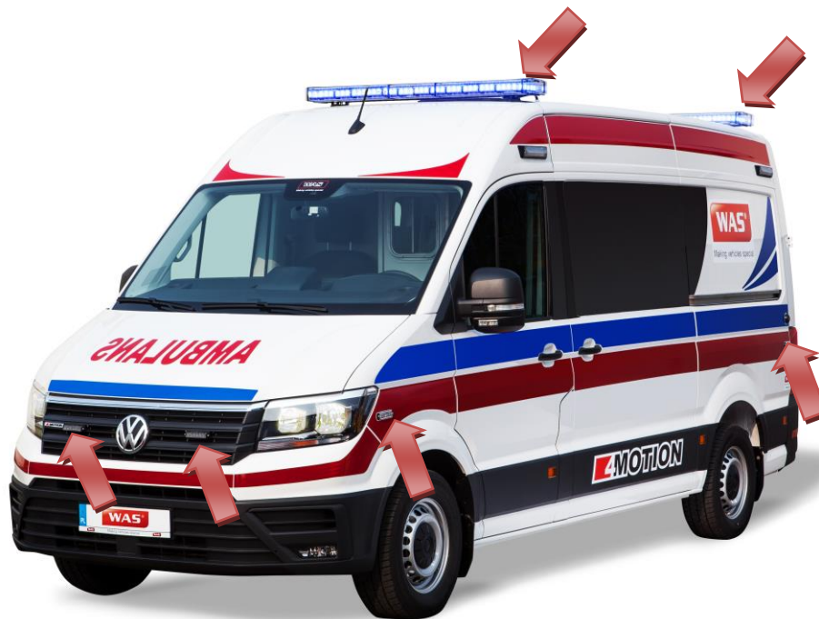
Rys. 33. Widok ambulansu z zamontowanym oświetleniem uprzywilejowanym.
