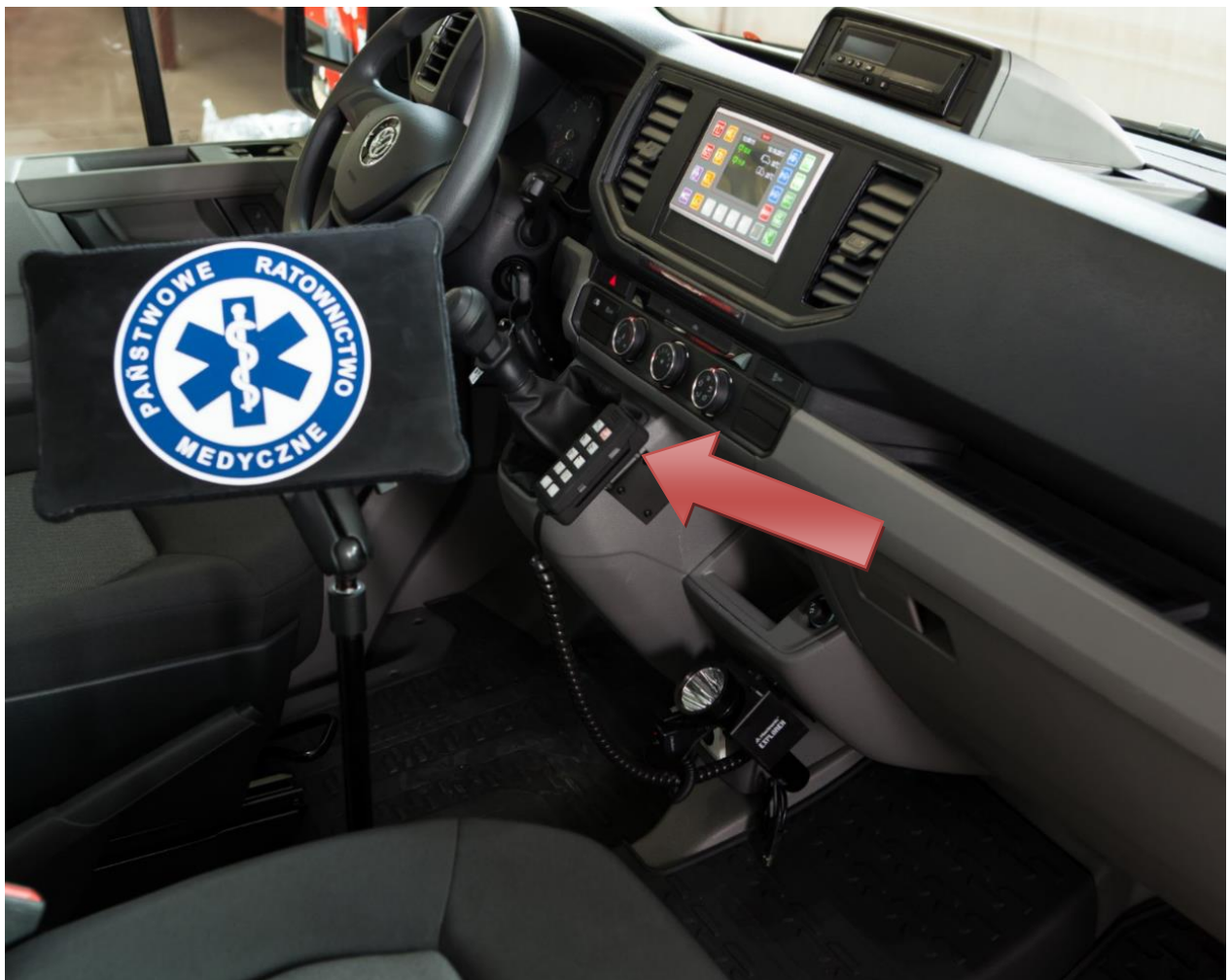
Rys. 32. Umieszczenie manipulatora w przedziale kierowcy
