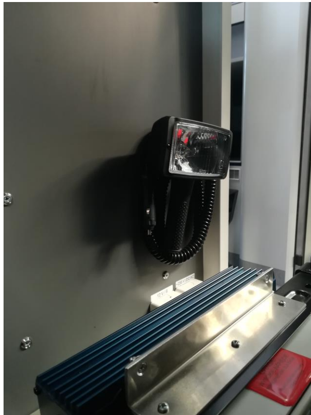
Rys. 42. Szperacz na elastycznym przewodzie w kabinie kierowcy
