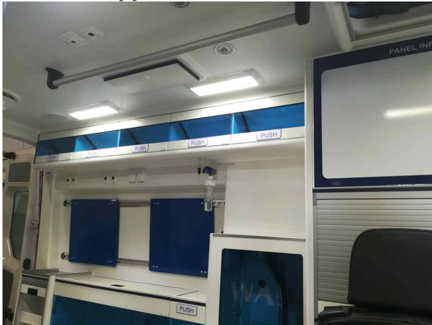
Rys. 35 Gniazda tlenowe z nawilżaczem tlenowym
