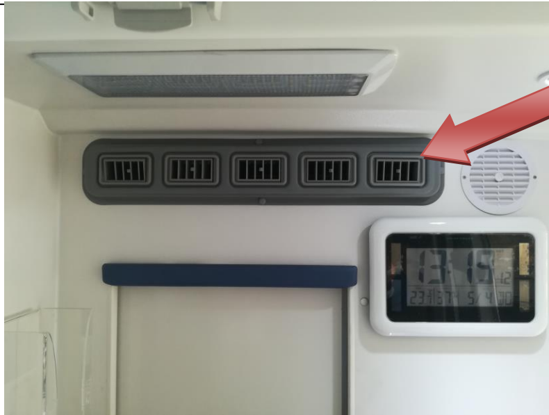
Rys. 22 Lokalizacja parownika klimatyzacji przedziału medycznego z czerpnią świeżego powietrza.
