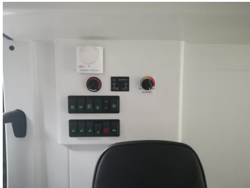
Rys. 19. Umieszczenie zestawu przycisków sterujących w przedziale medycznym.
