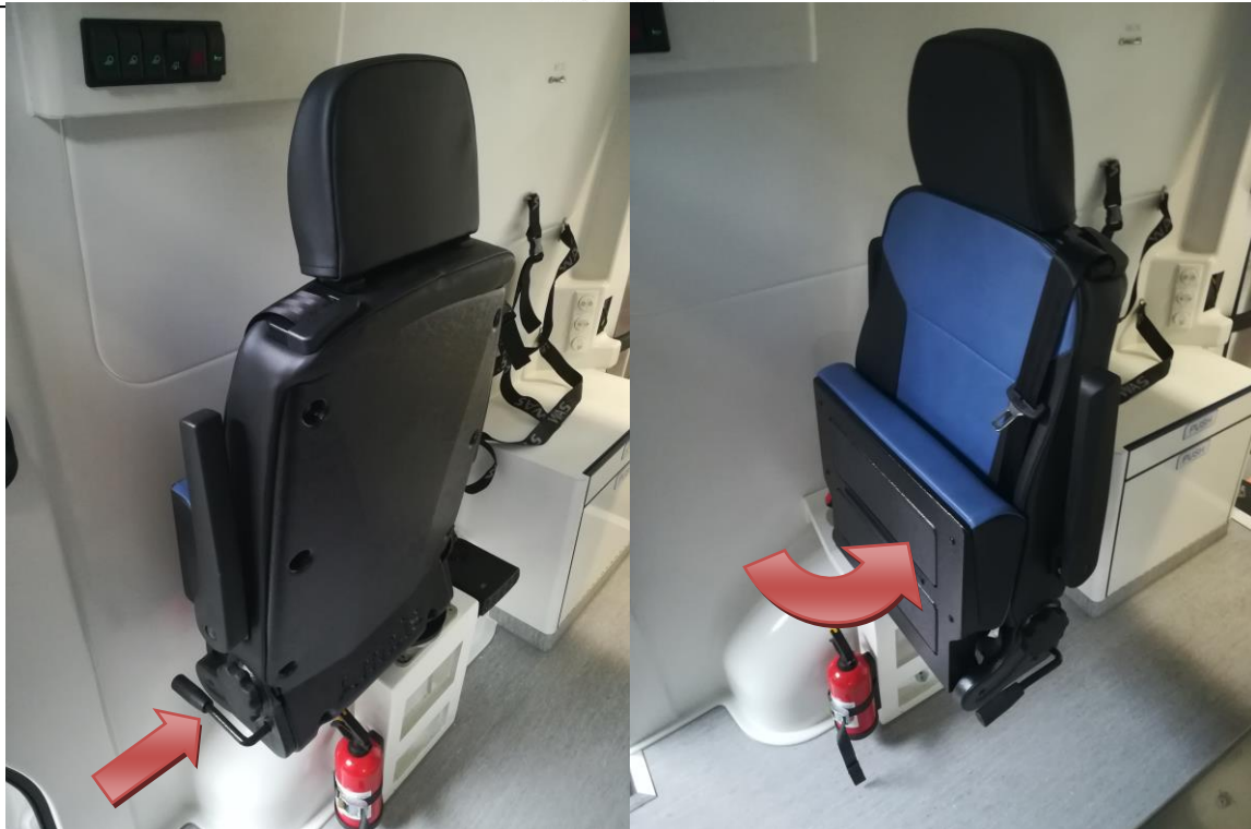
Rys. 50 Użycie dźwigni w celu obrotu fotela o kąt 90 0
