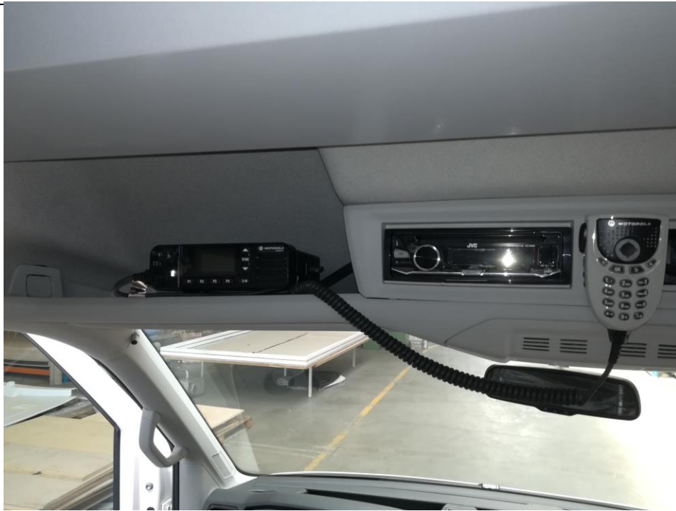
Rys. 40. Widok radiotelefonu w schowku nad głową kierowcy.
