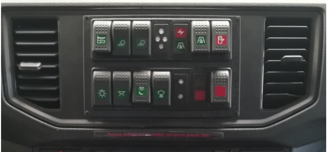
Rys. 18. Umieszczenie zestawu przycisków sterujących w kabinie kierowcy
