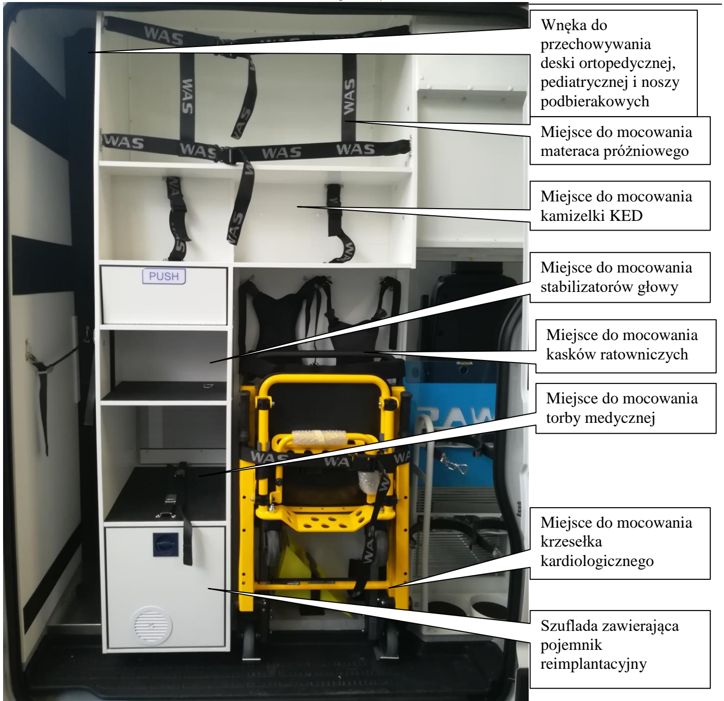
Rys. 65. Mocowanie sprzętu ortopedycznego za lewymi drzwiami przesuwными.
