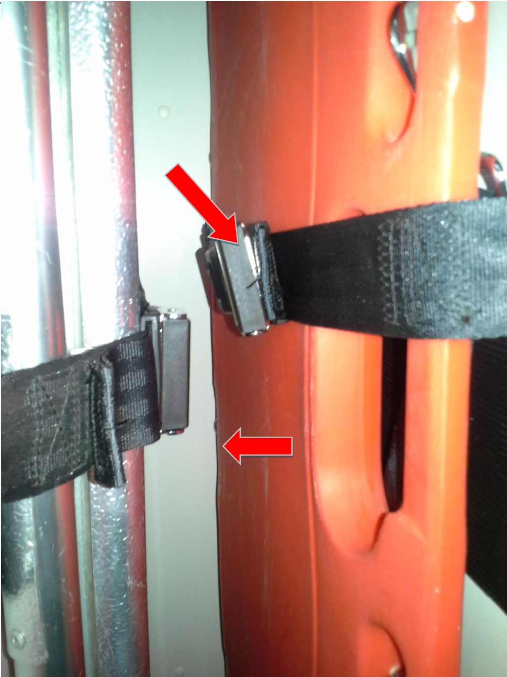
Rys. 66. Sposób mocowania noszy podbierakowych oraz deski ortopedycznej.
