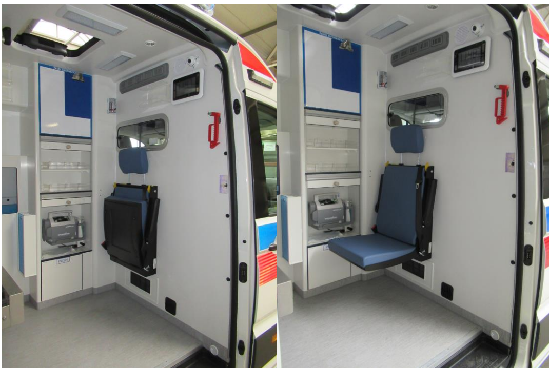
Rys. 54 Fotel Sim 2 zamontowany na ścianie działowej
