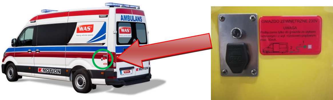
Rys. 4. Umieszczenie zewnętrznego gniazda zasilania 230V.
