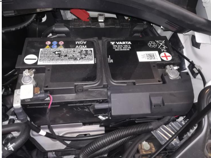
Rys. 7. Umieszczenie akumulatora dodatkowego z etykietą informującą
