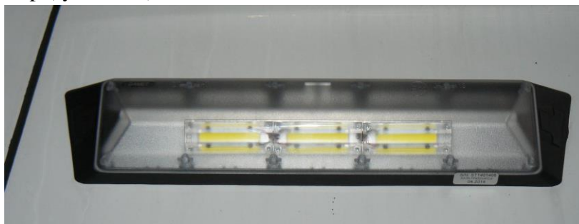
Rys. 29. Światła robocze umieszczone w obudowach zintegrowanych z nadwoziem pojazdu – lewa i prawa strona
