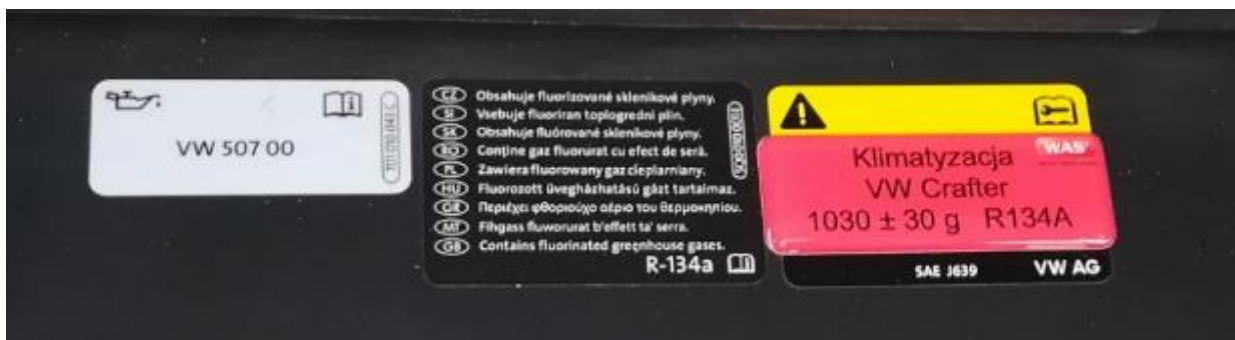
Rys. 23. Etykieta w komorze silnika informująca o koniecznej ilości gazu R134a.
