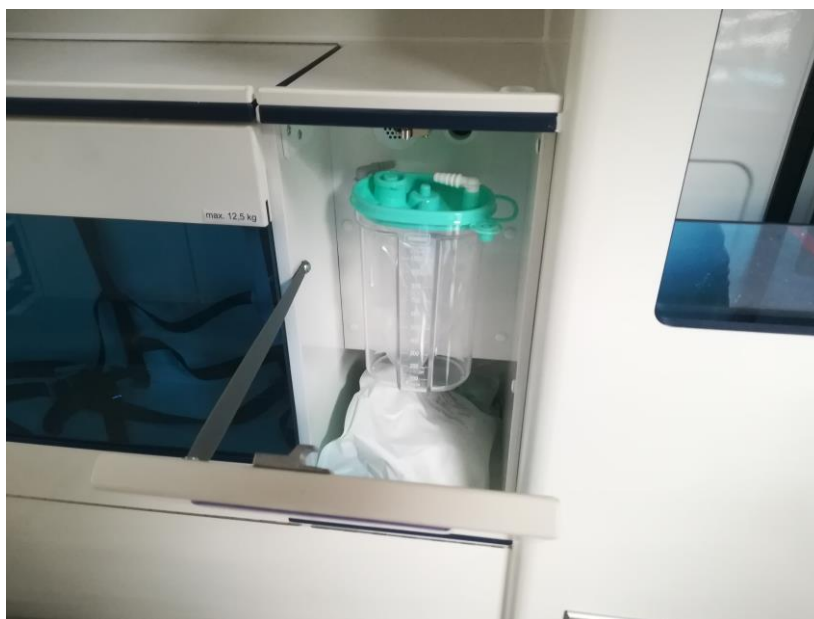
Rys. 36 Umieszczenie słoja próżniowego w pojeździe.
