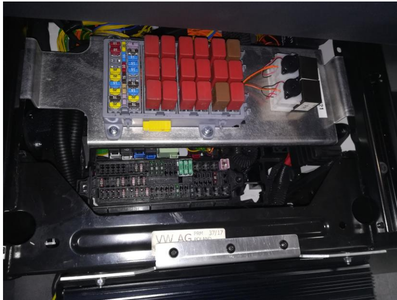
Rys. 68. Umieszczenie bezpieczników pod fotelem kierowcy.
