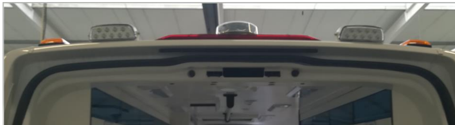
Rys. 31. Dodatkowe światła robocze wraz z kierunkowskazami
