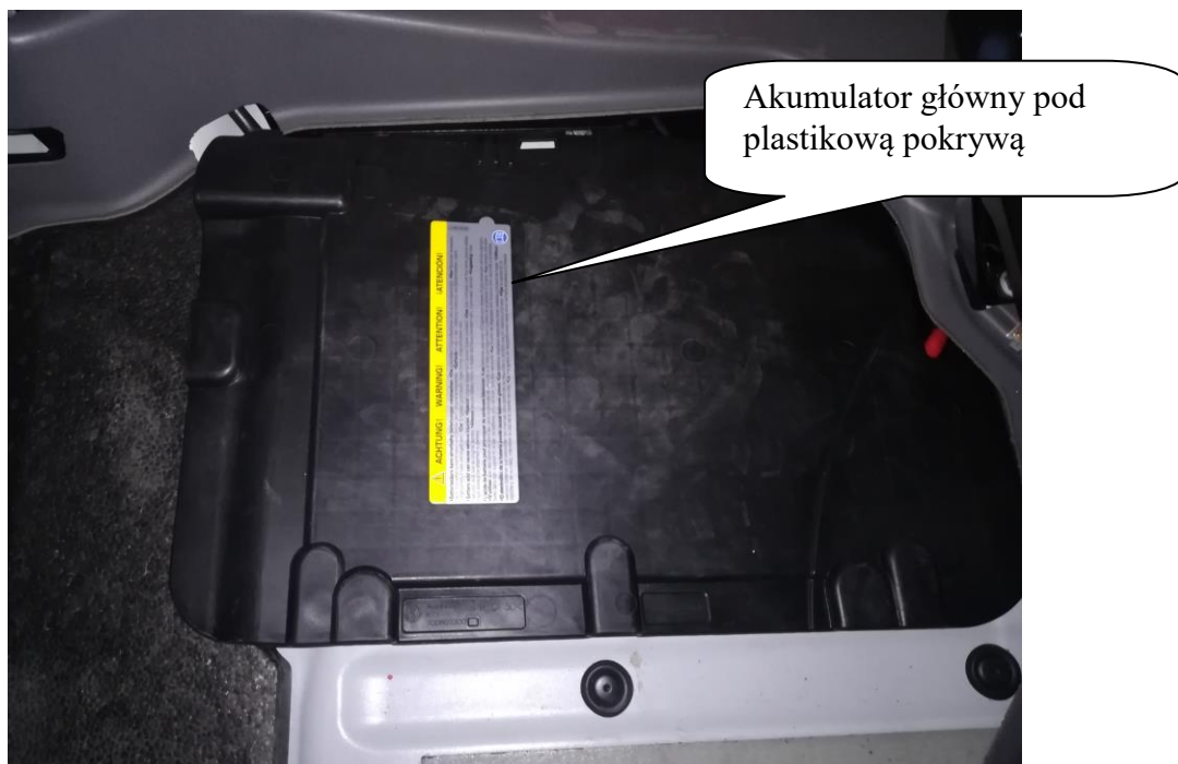
Rys. 6. Umieszczenie akumulatora głównego
