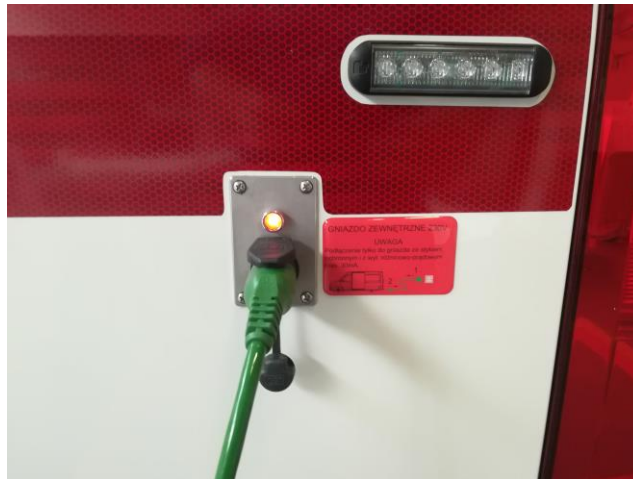
Rys. 67. Podpięcie zewnętrznego zasilania 230V.
