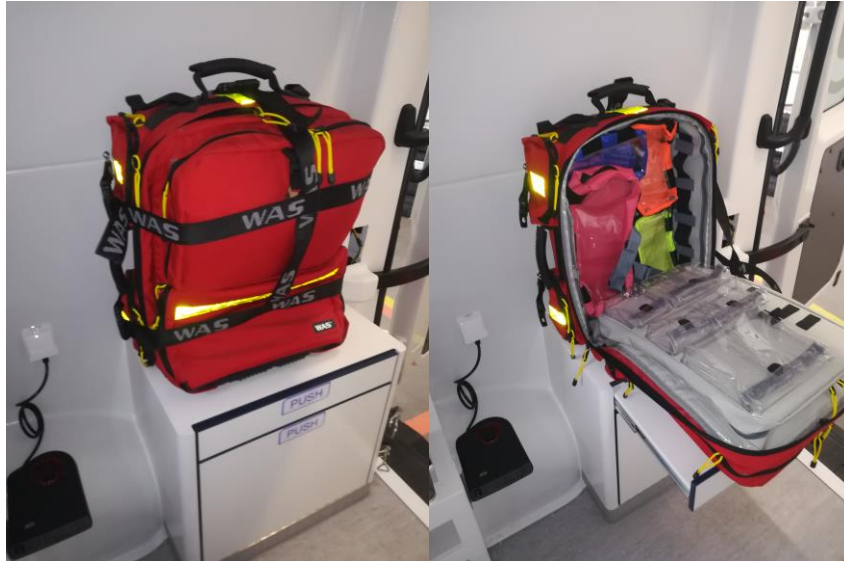
Rys. 60. Szafka z wysuwającym blatem roboczym w prawej tylnej części pojazdu.
